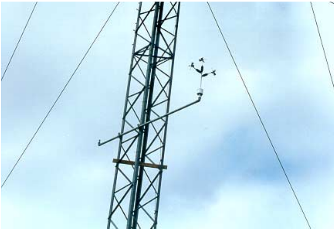
Mynd 6. Vindmælir í 10 metra hæð á Leirum. Mælirinn er af gerðinni Gill UVW og mælir hraða í þrjár áttir. Út frá niðurstöðunum má reikna út vindátt og vindhraða. Ljósmynd: Hreinn Hjartarson.
