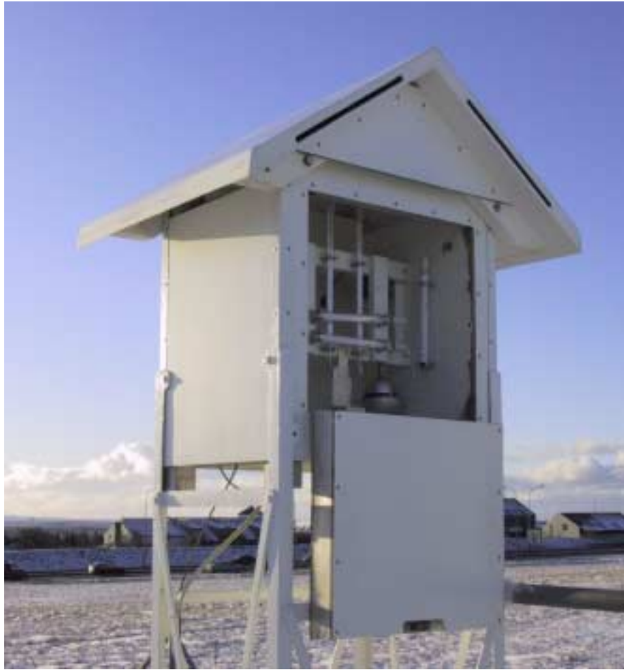
Mynd 2: Mælaskýli á mönnuðum veðurstöðvum. Í skýlinu sést m.a. í þurran og votan kvikasilfursmæli, hámarks- og lágmarksmæli. Myndin er úr mælireit Veðurstofunnar í Reykjavík. Ljósmynd. Hálf dán Ágústsson 7. nóvember 2001.
