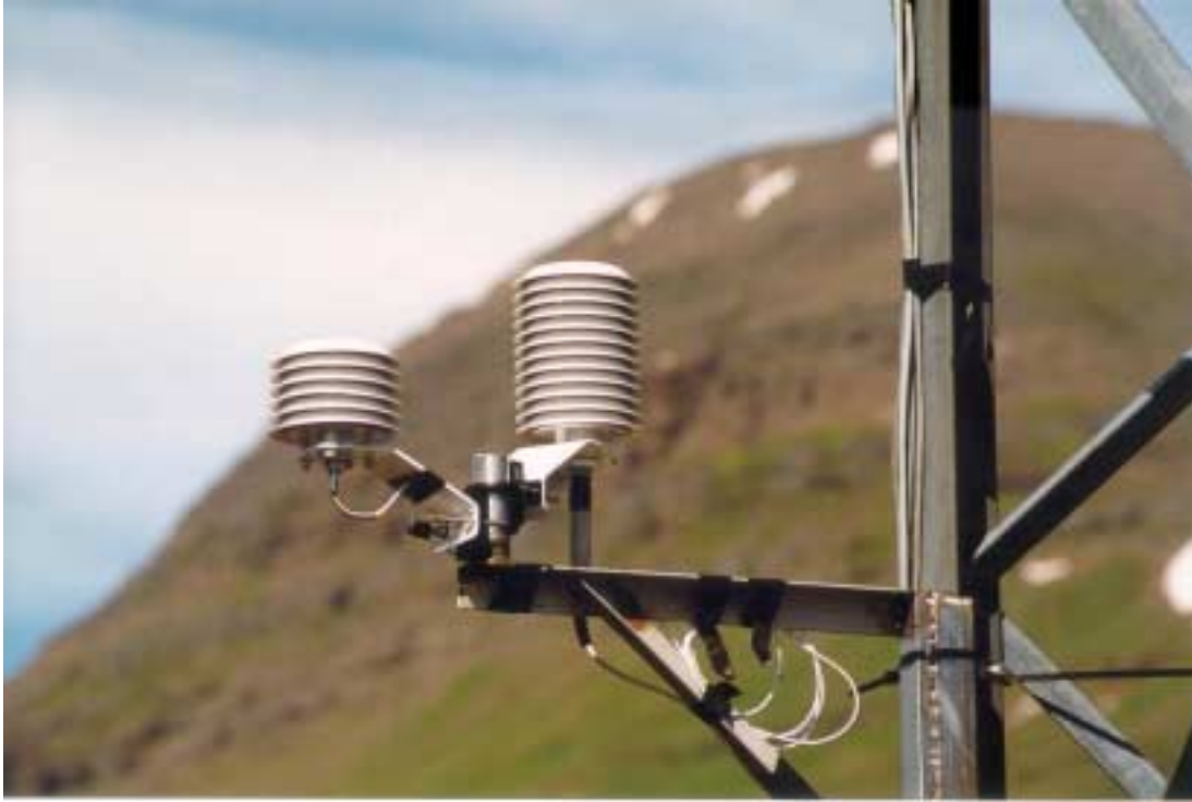
Mynd 1: Hlífur af sjálfvirkum mælum festar á stálgrind. Minni hlífin er fyrir hitamæli, en sú stærri fyrir rakamæli. Myndin er af stöð í Sómastaðagerði í Reyðarfirði. Ljós. Flosi Hrafn Sigurðsson, 25. júlí 1999.
