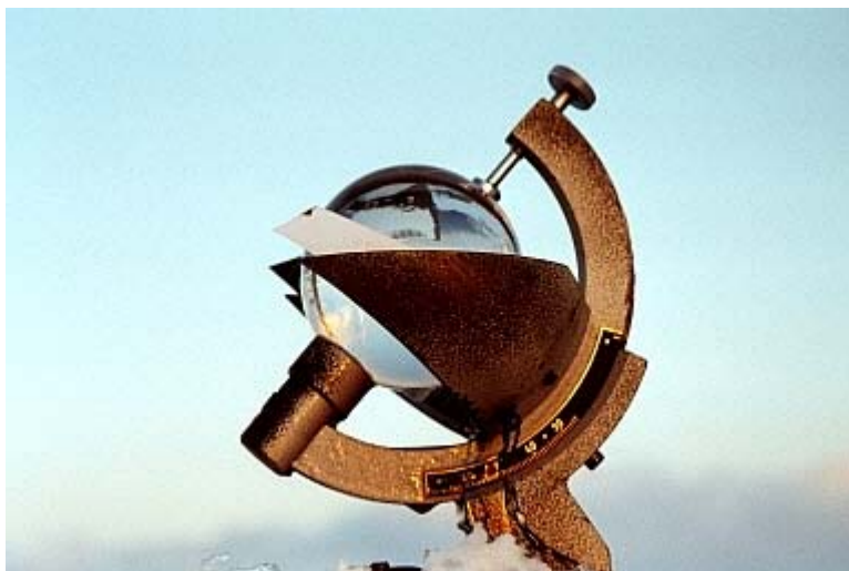
Abb. 3.1.1: Sonnenscheinautograph nach Campell-Stokes [5].
