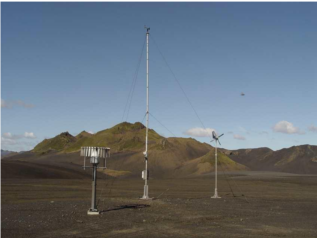
Mynd 2: Sjálfvirk veðurstöð við Lónakvísl, skammt vestan við Langasjó. Stöðin er í eigu Landsvirkjunar og er í 675 m y.s. Á myndinni má sjá mælímastur, úrkomumæli og vindrellu. Myndin er tekin 14. júlí 2005. Ljósmynd: Sigvaldi Árnason.
